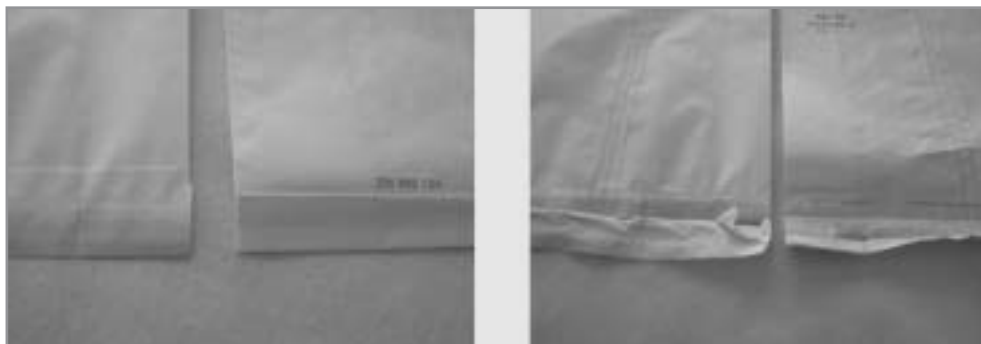
Figura 3. Envases con cierre con plegado sencillo (izqda.) de ambas fotos y con doble plegado (dcha.)
