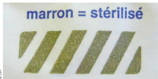
• Figure 7b. Indicateur de passage après stérilisation.
