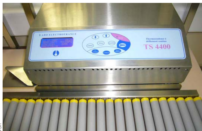
• Figure 13. Soudeuse à défilement.
