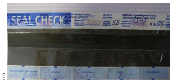
• Figure 15. Test bandelette Seal Check® après stérilisation.
