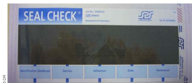
• Figure 14. Test bandelette Seal check® avant stérilisation.
