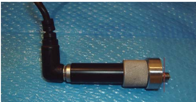
Motor del microqueratomo. La línea roja delimita la zona de inmersión.
