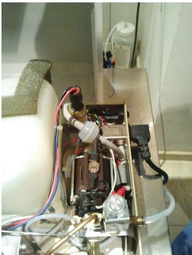
Algunos componentes internos que hay que cambiar periódicamente.
