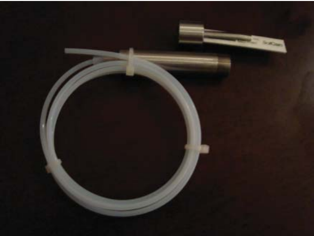
Test de penetrabilidad o prueba HELIX.
